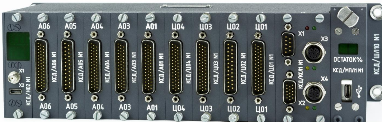
Рисунок 1.1 Внешний вид КСД «Базис»: шасси с установленными модулями приёма сигналов, контроллером сбора и съёмным модулем памяти
